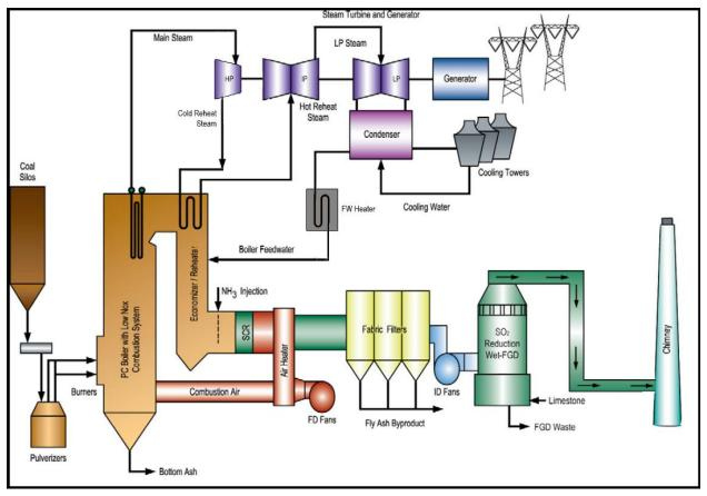
FIGURE 3-1 – ULTRA SUPERCRITICAL COAL DESIGN CONFIGURATION
